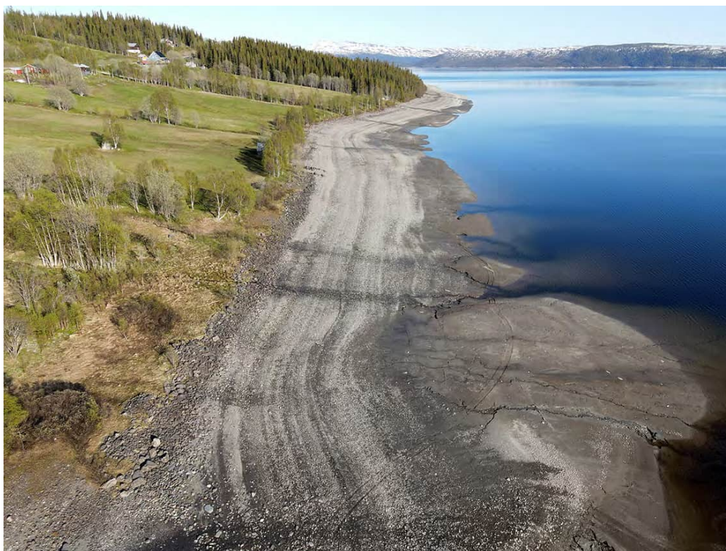
Figur 92. Stora Blåsjön, Jämtland, regleras kraftig för kraftproduktion. Stränderna eroderas av våg- och ispåverkan vid olika vattenstånd. Bild från början av juni 2020. Den utarmade strandzonen leder till en oligotrofieringsprocess (minskade närsaltnivåer) och till slut minskar fiskproduktionen (Milbrink m fl 2011). Foto: Erik Degerman.
