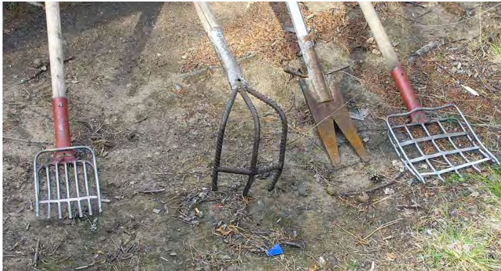
Figur 169. Fyra specialutvecklade redskap för Hartijoki-metoden vid etablering av lekbottnar för öring. Med de två mittersta redskapen (kratta respektive spett) luckras botten upp och större sten och block flyttas. Det högra redskapet (sikten) används sedan för att ta bort mindre sten som anses för stora (>5 cm) som leksubstrat. Det vänstra redskapet (skyffel) används för att sälla ut och flytta lämpligt lekmaterial. Detta flyttas till den nya lekbotten. Redskapen kan man tillverka själv eller beställa på hemsidan för Nilivaara sportfiskeklubb. Foto: Erik Degerman.
