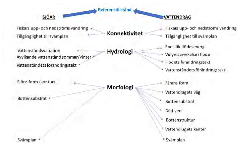
Figur 44. De enskilda faktorer som bedöms i sjöar respektive vattendrag för att beskriva hydromorfologisk status.
