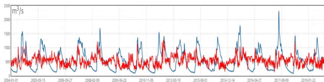
Figur 93. Vattenföring i Luleälven åren 2004–2019 (röd linje), jämfört med modellerad vattenföring utan reglering (blå linje) samma period. Extrema hög- och lågflöden har blivit ovanligare. Data SMHI Vattenweb.
