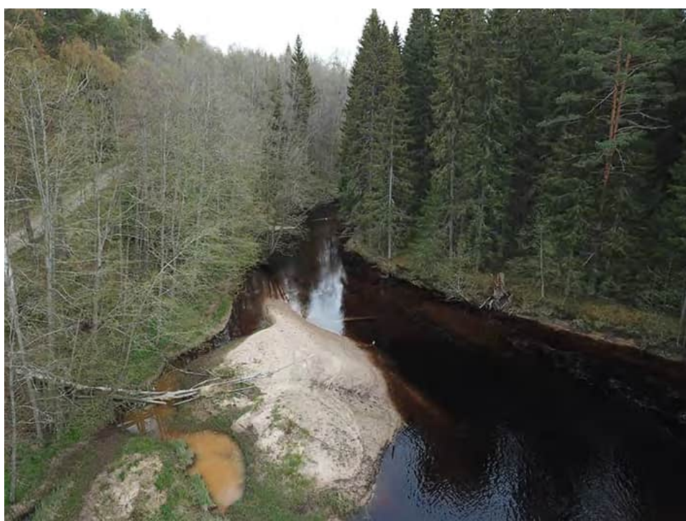
Figur 107. Tillfällig ansamling av sediment (fin sand) på första lugnsträckan efter utrivning av dammen vid Nedre Borgfors, Hedströmmen. Foto: Erik Degerman.
